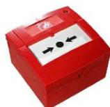
Bouton poussoir incendie RF interconnectable aux détecteurs incendie RF de Ei. Fonctionne sur pile lithium 10 ans, led pour indication d'état. En pressant le bouton-poussoir, la sirène intégrée dans chaque détecteur autonome s'active.
