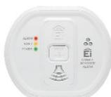
Détecteur de CO autonome avec pile lithium pour la durée de vie du détecteur, interconnectable via module RF intégré. Témoins Led pour indication de l'alimentation, alarme et défaut. Bouton pour test et pause.
