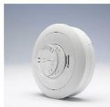
Détecteur d'incendie autonome thermique (58°C) à pile lithium durée de vie 10 ans, interconnectable par câble et via module RF optionnel, max. 12 dispositifs RF. Bouton test.
