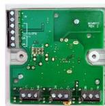
Module d'interface panneau 9-30VDC pour détecteurs RF incendie et CO de Ei. Trois sorties relais distinctes pour défaut, alarme incendie et alarme CO et entrée pour activer la sirène intégrée dans chaque détecteur.
